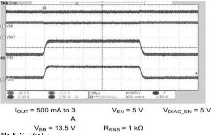
Fig. 8. V<sub>SNS</sub> for I<sub>VBB</sub>
