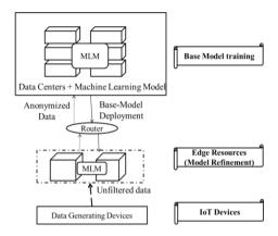
Fig. 2. Edge AI with hierarchical edge architectures
